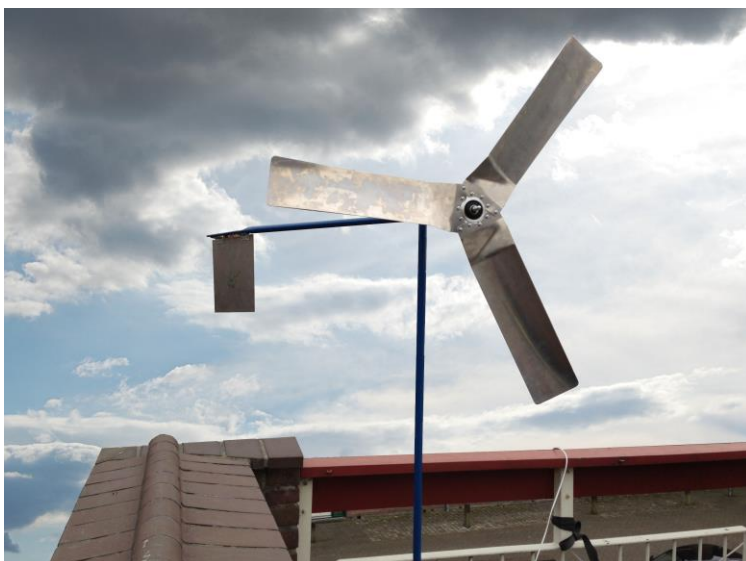
De VIRYA-1.04 met een NEXUS naafdynamo als generator
