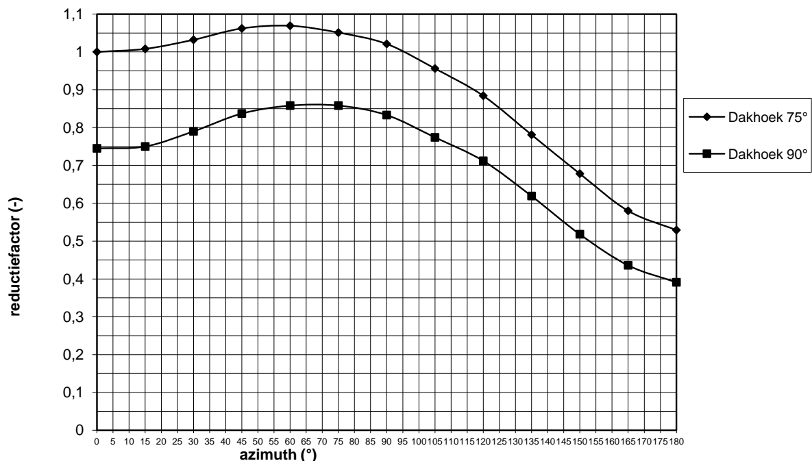
Figuur 2 Reductiefactor als functie van de dakhoek en de azimuth t.o.v. een paneel met een dakhoek van 75^\circ en een azimuth van 0^\circ voor de maand juni
